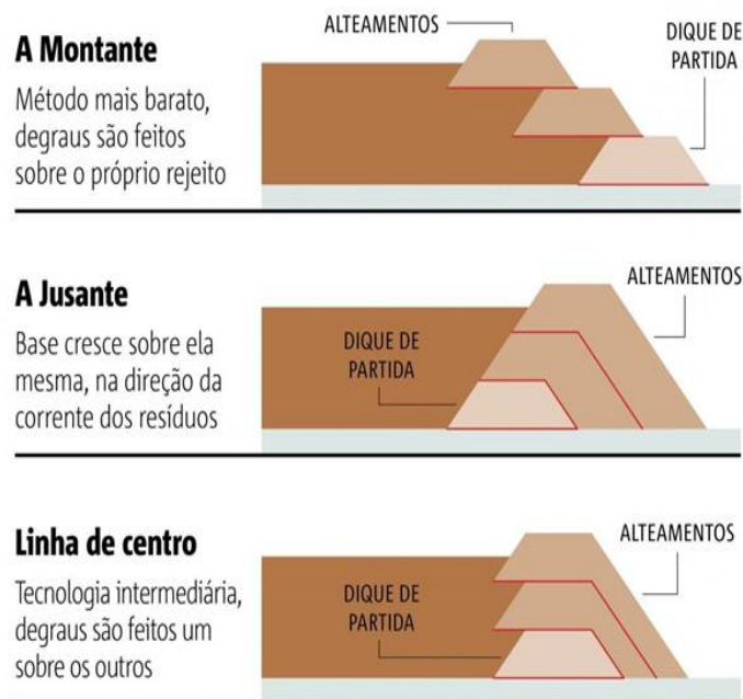
Figura 1 - Representação dos tipos de barragens.
