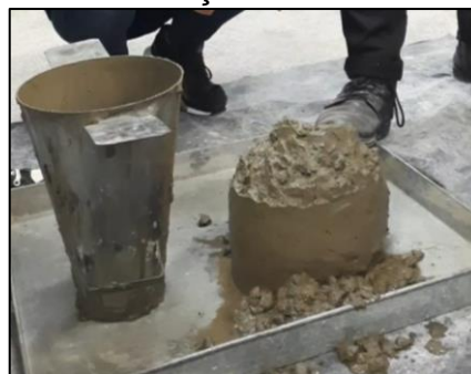
Figura 1 - Remoção do molde metálico
