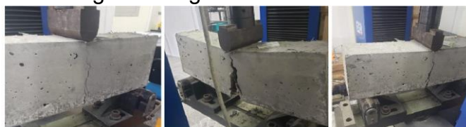
Figura 3: Vigas do ensaio de flexão
