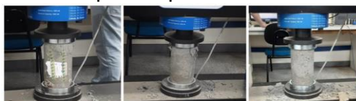
Figura 5: Corpos de prova no ensaio de compressão
