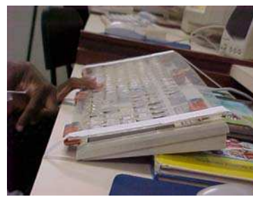
Figura 6 - Máscara de teclado sobreposta ao mesmo
