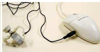
Figura 14 – Acionador confeccionado com botão liga/desliga de computador
