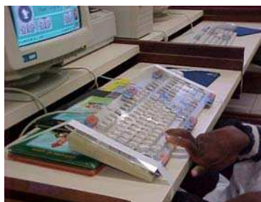
Figura 8 - Teclado com alteração na inclinação e fixado à mesa
