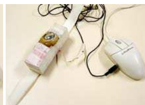
Figura 15 – Switches para acionamento com a cabeça, feito com botão grande de sucata
