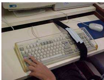
Figura 5 - Máscara de teclado encaixada no mesmo
