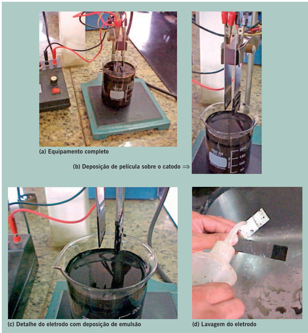
Figura 2.38 Esquema do ensaio de carga de partícula de uma emulsão asfáltica
