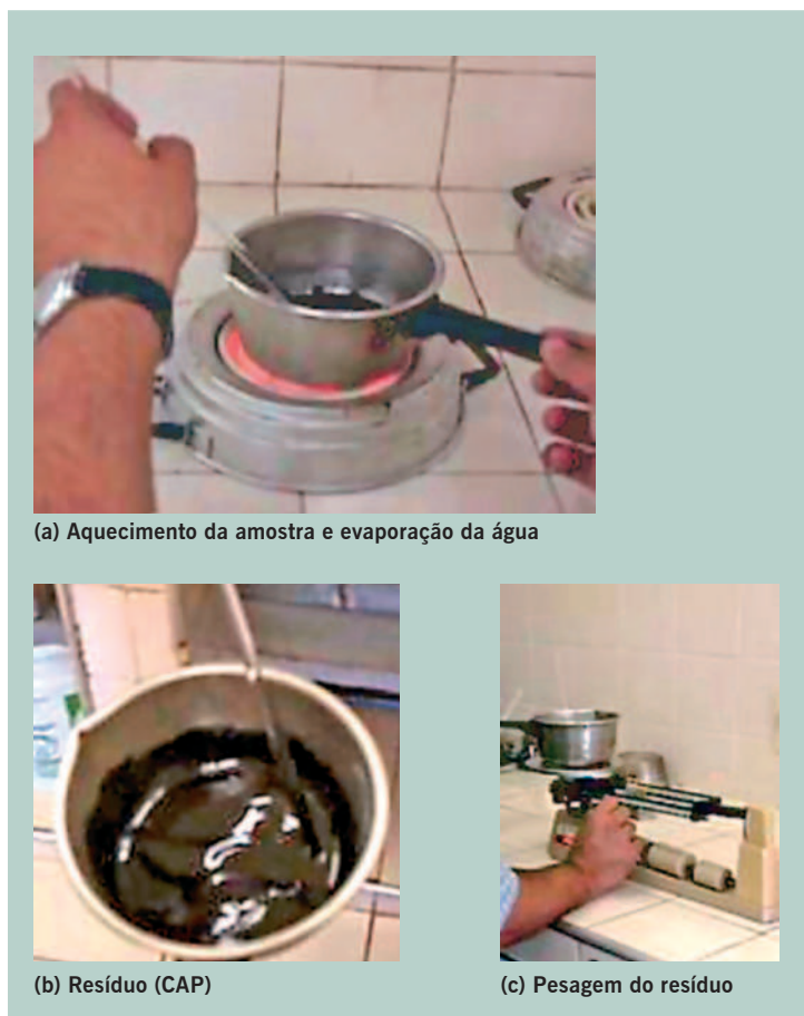
Figura 2.42 Exemplos de passos do ensaio de determinação do resíduo por evaporação
