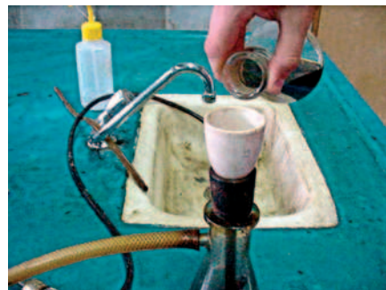
(d) Filtração, com auxílio de vácuo, da amostra dissolvida em tricloroetileno
