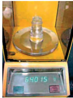
(b) Determinação da massa do picnômetro totalmente preenchido com água a 25°C
