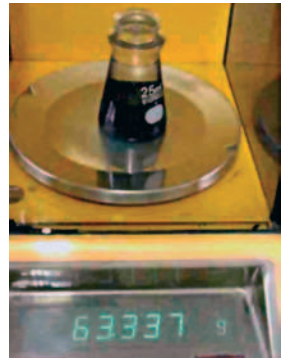
(d) Determinação da massa do picnômetro preenchido metade com água e metade com asfalto, a 25°C
