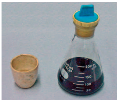
(c) Amostra dissolvida em tricloroetileno para filtração no cadinho
