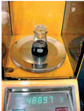
(c) Determinação da massa do picnômetro preenchido até a metade com asfalto a 25°C
