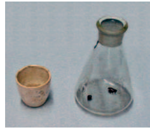
(b) Cadinho com papel-filtro no interior e erlenmeyer com a amostra antes da filtração
