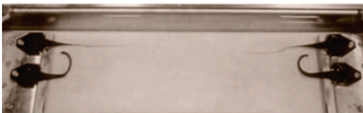
(c) Ruptura do ligante asfáltico
