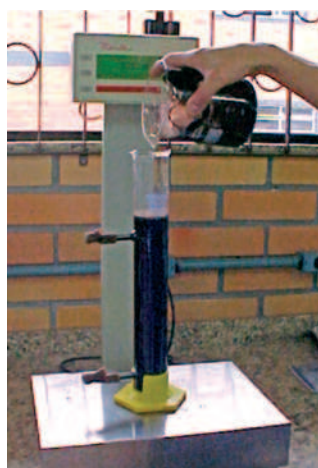
(b) Carregamento do equipamento de sedimentação com a emulsão
