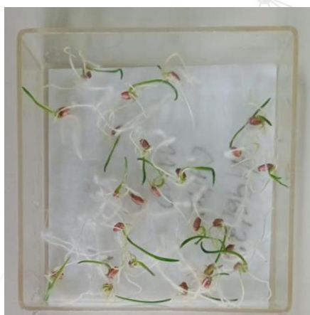
Figura 3: Blotter test feito em gerbox com sementes de trigo.
