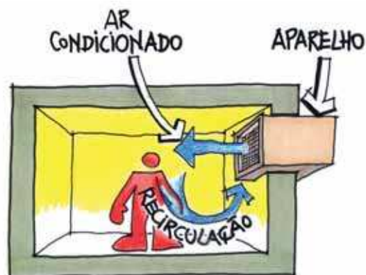
Figura 8-22: Ar condicionado de janela
