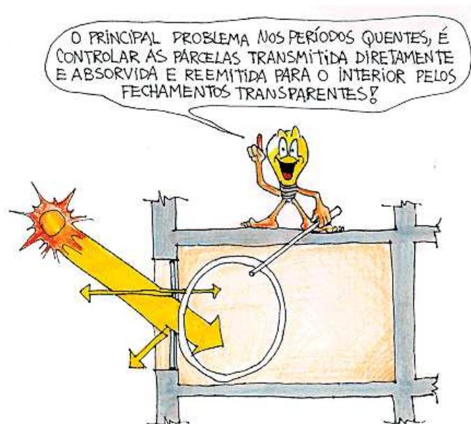
Figura 7-2: Radiação transmitida, absorvida e refletida pelo vidro
