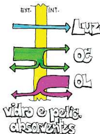
Figura 7-11: Comportamento das películas e vidros absorventes à OC, OL e luz visível
