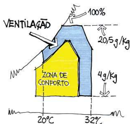
Figura 3-20: Zona de ventilação
